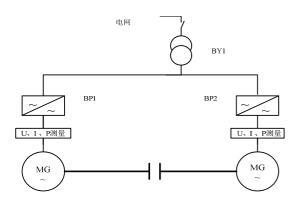
系统包括拖动系统、被试电机、并网变频器、测试 设备等。拖动系统包括拖动变频器、拖动电机。电网经 变压器 BY1 变为 690V 电压给拖动变频器 BP1 供电,拖动电机 MG1 在拖动变频器 BP1 的控制下作电动机运行,拖动被试电机 MG2 旋转发电。MG2 发出的电能经4 象限变频器整流逆变为 50Hz/690V 的交流电,回馈交流母线。即发电机发出的电能提供给电动机使用,固变压器 BY1 只需补充两台电机的损耗即可,其从电网吸收的有功功率为两台电机及变频器的总损耗。
