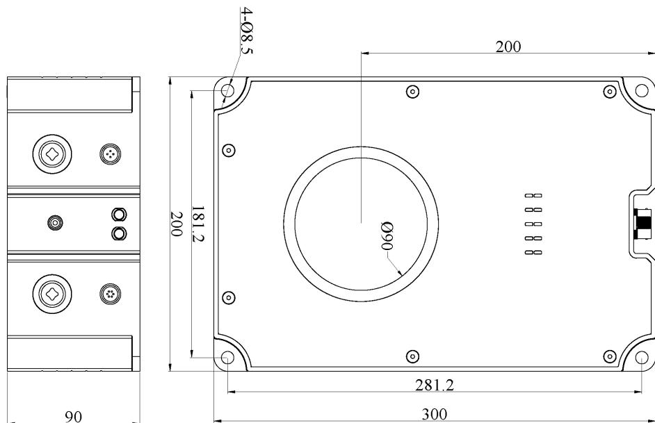
**4.2.2 低压大电流传感器尺寸 (单位 mm)**
