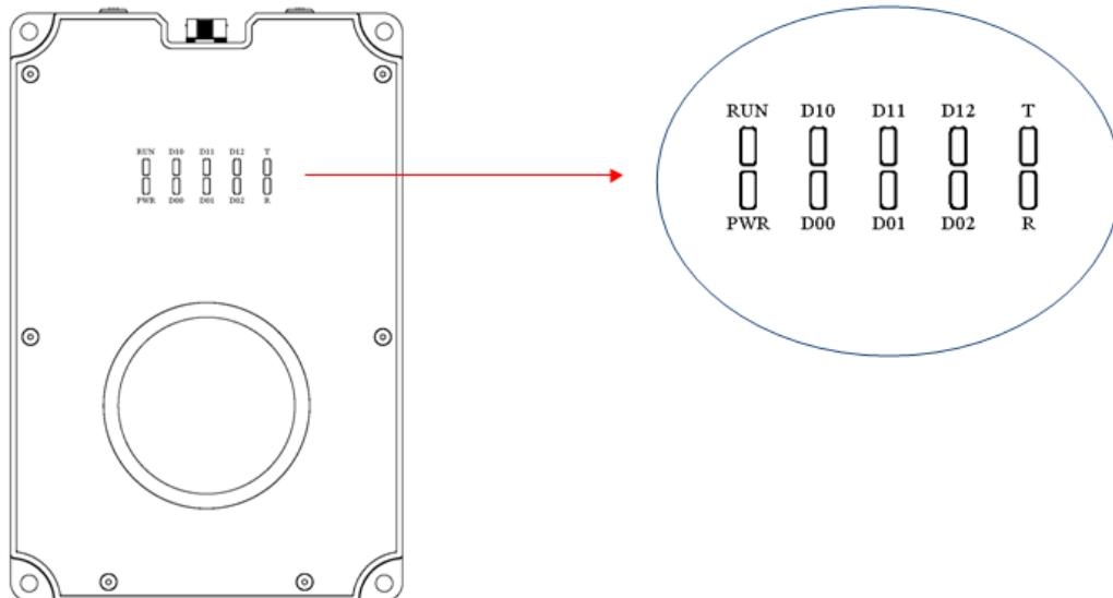
除低压小电流之外，其他三种结构的 SP 变频功率传感器均配置状态指示灯，指示灯定义如下：
