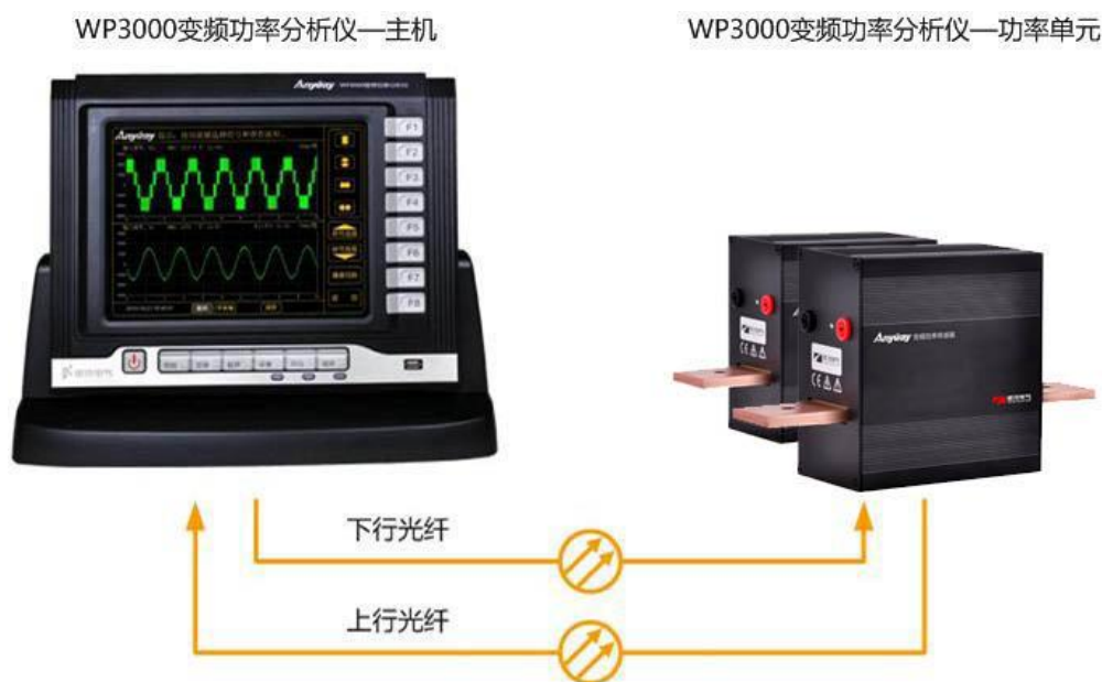
宽频带高精度功率分析仪——WP3000 变频功率分析仪的构成原理
