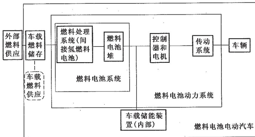
图 1 燃料电池电动汽车系统框图
